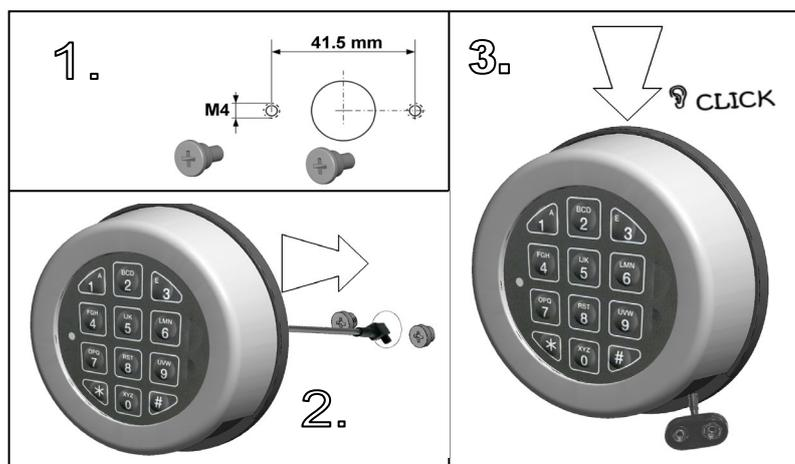
Vissez les deux adaptateurs de montage avec les 2 vis M4 (vissé à la main). Glissez le câble dans le trou et fixez l'unité d'entrée aux adaptateurs de montage. L'arrière doit poser à plat sur la porte du coffre. Contrôlez l'entrée de câbles, puis poussez le clavier de haute en bas jusqu'à ce qu'il est fixée.
