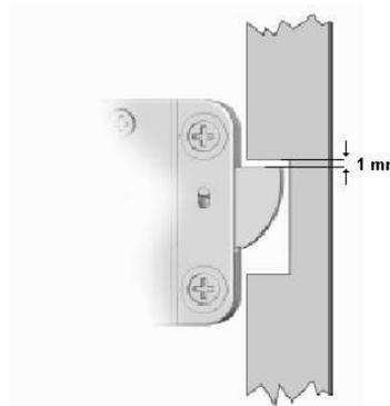
**Ne serrer trop les vis de fixation, torsion maximale 3,5 Nm.**
