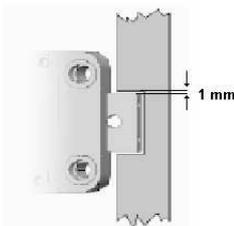
En position de fermeture, la distance entre le pêne et le mouvement doit être d'environ 1 mm.
