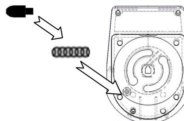
Couper l'axe pour obtenir une longueur adapté à l'installation. Déterminer l'épaisseur de la porte (à partir de la base de fixation du clavier jusqu'au la base de fixation de la serrure et rajouter 40 mm)
