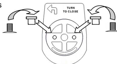
Visser la base pivotante au clavier T9530 utilisant les vis fournies.
