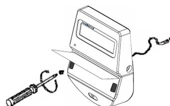
Enlever l'autocollant de la membrane du clavier et aligner les bords en position correcte avant de le coller.
