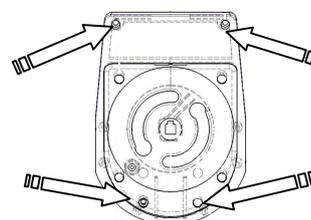
Insérer le ressort et le pivot dans le trou positionné au verso de la base de fixation
