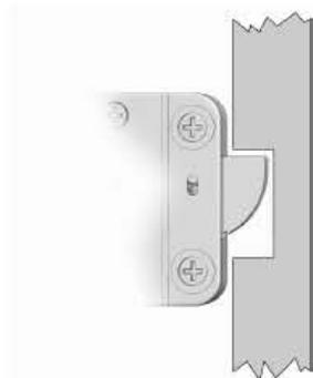
En position de fermeture, la distance entre le pêne et le mouvement doit être d'environ 1mm.
