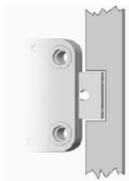
En position de fermeture, la distance entre le pêne et le mouvement doit être d'environ 1mm. Le pêne doit bouger librement.
