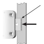
Im verschlossenen Zustand (Bolzen vorgeschoben) soll der Abstand der Sperrstelle zum Schlossriegel ca. 1mm betragen. Der Schlossriegel muss lastfrei in die Sperrposition laufen.
