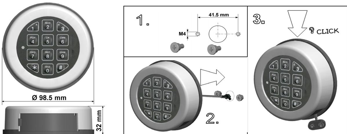
Befestigen Sie die zwei Montage-Anschluss-Schrauben (M4) handfest. Führen Sie das Kabel durch das Kabel-Loch und schieben die Einheit auf den Montageschrauben. Die Rückseite der Einheit muss die Türoberfläche berühren.
