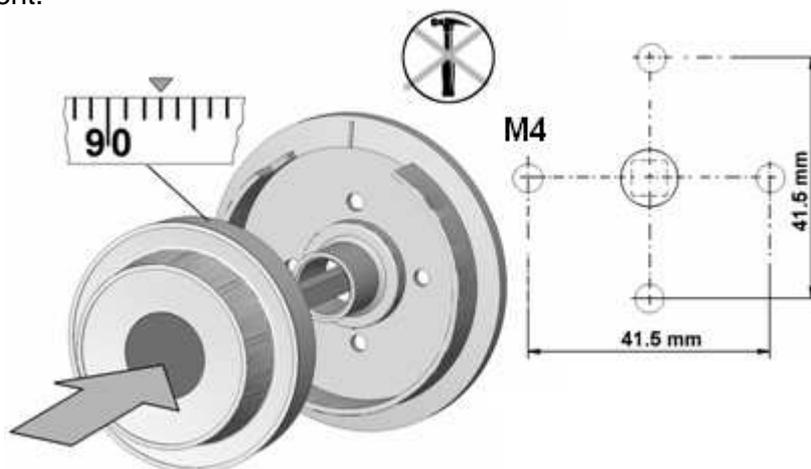
Den Zahlenknopf auf ca. "93" stellen und die Vierkantspindel mit etwas Druck (gegen die Klemmscheibe) in das geöffnete Schloss schieben. Die Spindel ist gegen Herausziehen gesichert. **Der Zahlenknopf benötigt kein axiales Spiel.**
