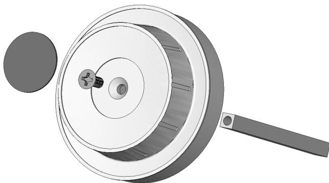
Spindel in das Vierkantloch im Zahlenknopf stecken und mit der mitgelieferten Senkkopfschraube handfest anschrauben. Stellen Sie sicher, dass die Spindel komplett in der Vierkantaufnahme sitzt und nicht im Bereich der oberen Sechskantöffnung verkantet ist. Die grössere schwarze Abdeckplatte aufkleben, die kleinere wird nicht benötigt.
