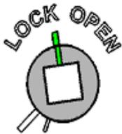
Das Schloss wird geliefert mit eingefahrenem Riegel und muss auch so montiert werden. Beachte das der Cam (Teil mit vierkant Loch) und Riegel nicht bewegen. **Während Montage soll der Riegel eingefahren sein und der Cam in Position wie in Abbildung hierneben.**
