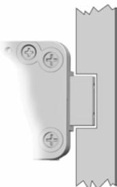
Den Zahlenknopf LINKS drehen und den Riegel ausfahren. Der Riegel muss lastfrei in die Endposition laufen, und darf vom Riegelwerk nicht behindert werden.
