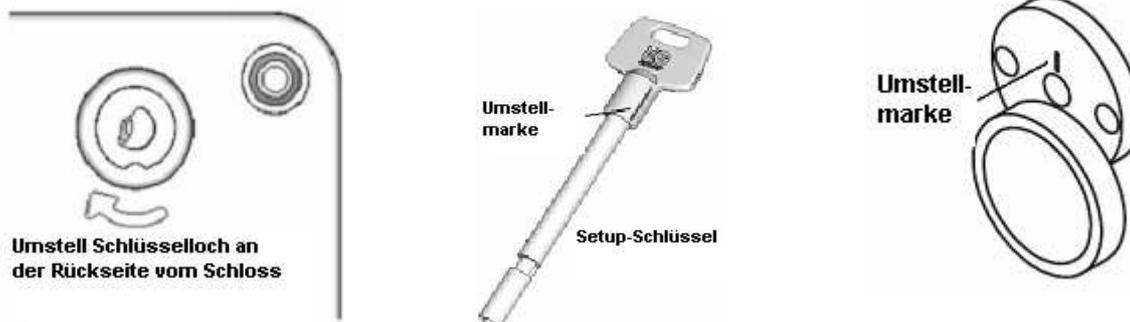
Umstellschlüssel in die gleichgeformte Öffnung im Schlossdeckel (Türinnenseite!) einführen und ohne Gewalt nach Rechts drehen bis zum Stop (ca. 90°) wie beim Kombinationsschloss. Schlüssel bis zum Anschlag links drehen und herausnehmen.
