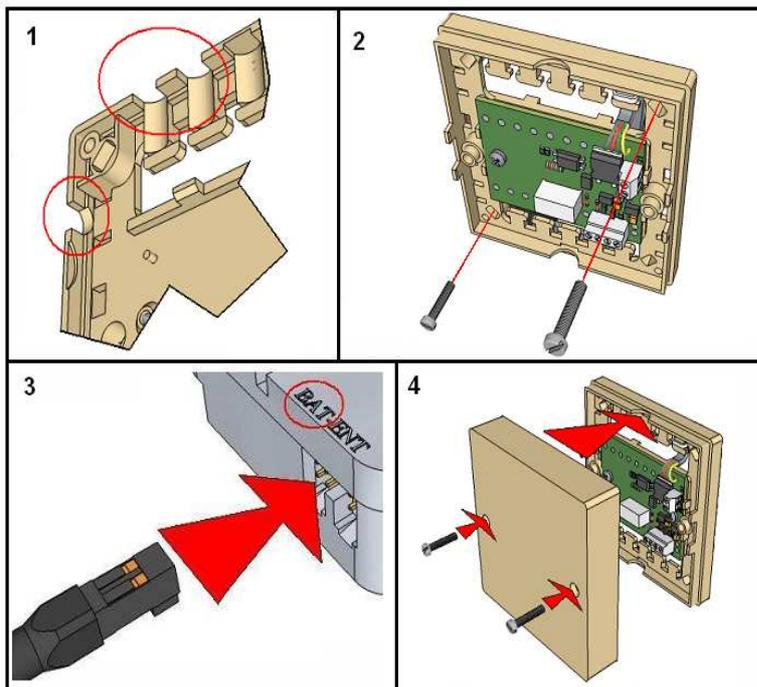
1. Machen Sie den Ausschnitt im Deckel für das Kabel groß genug, das auf der Unterseite verlegt wird.
