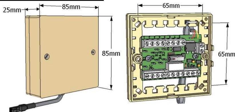
Bei der Positionierung der Box stellen Sie sicher, dass die Box oder das Kabel keine beweglichen Teile des Riegelwerks bei der Anwendung behindern können. Die Kabellänge ist ca. 350mm (nutzbar). Entgraten Sie die Bohrlöcher (2xM3 Schrauben mind.) und säubern Sie die Oberfläche.
